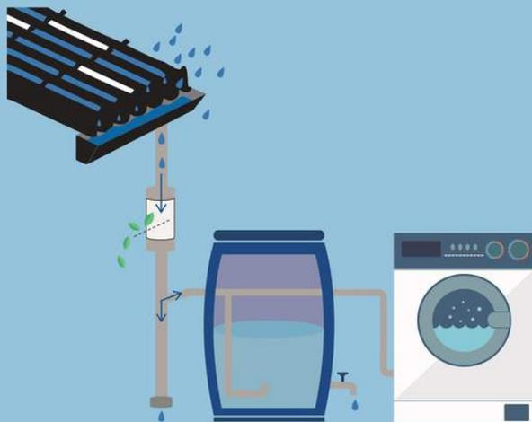
Esta práctica consiste en la captación de agua de lluvia que cae en los techos de las casas y galerones. El agua captada es almacenada y usada según las necesidades. Las áreas de captación y los depósitos pueden ser de dimensión muy variada según la intensidad de la lluvia, la cantidad de la misma y los requerimientos de la finca.
